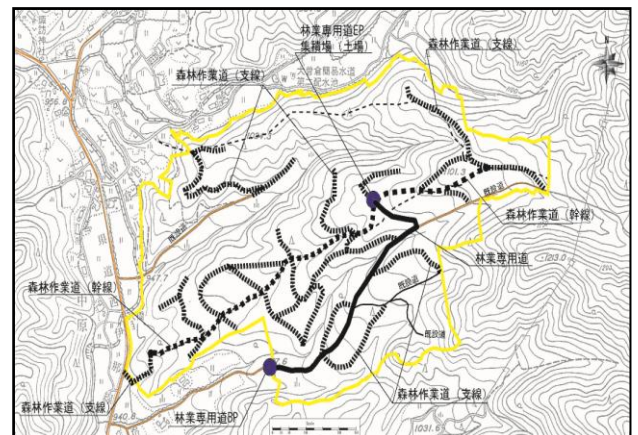
図-4 概略路網配置図 (黒実線が林業専用道。黒破線が森林作業道) (指針より)
