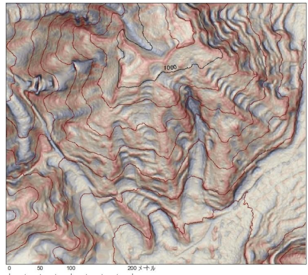
図-9 微地形図（長野県林業総合センター作成） ※航空レーザ測量1mメッシュDEMをGISソフトによって図化したもの
