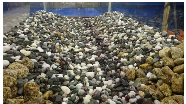
写真 9 複断面型の河道模型（1/20 scale）
