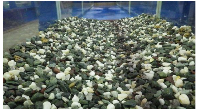
写真 8 緩傾斜型の河道模型（1/20 scale）
