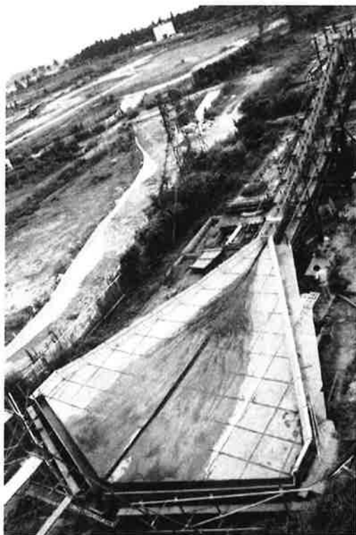
写真-4 扇状地における流木の堆積に関する水理模型実験状況、扇状地部の長さは12m、幅は10.6m、勾配は0.5°～10°、上流水路部は長さ14m、幅20cm、勾配は12°～30°
