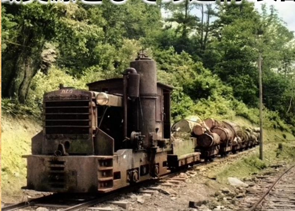
加藤製作所製木炭瓦斯発生装置付き5tディーゼル機関車（津軽森林鉄道）
